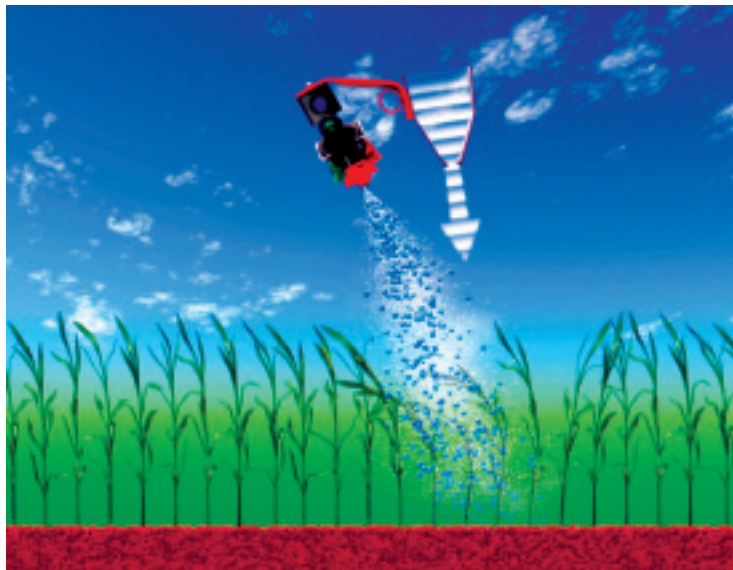
Рис. 22. Технологическая схема подачи рабочего раствора в прикорневую часть зерновых колосовых культур
