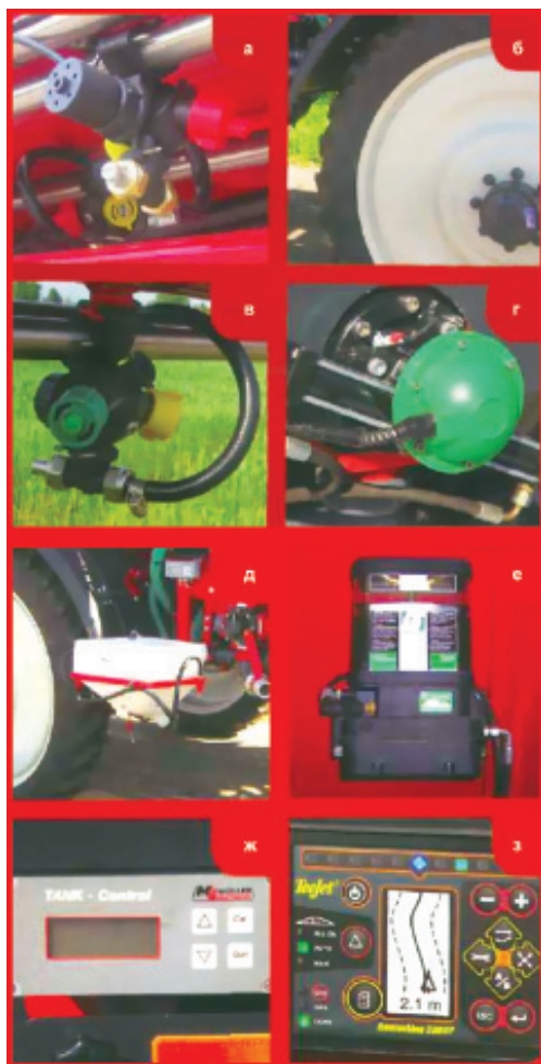
Рис. 15. Особенности конструкции опрыскивателя «Condor»: а – пневматическая насадка для включения и выключения распылителей; б – шины разных размеров; с – система смешивания воздуха и рабочей жидкости; d – пятиходовой главный клапан с гидравлическим управлением; e – емкость с системой промывки баков; f – автоматическая система смазки; g – электронный индикатор уровня рабочей жидкости в баке; h – система GPS для отслеживания колеи и поворотной полосы
