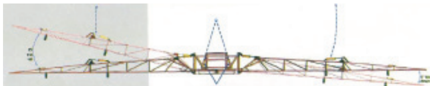
Рис. 25. Самовыравнивающая маятниковая конструкция штанги
