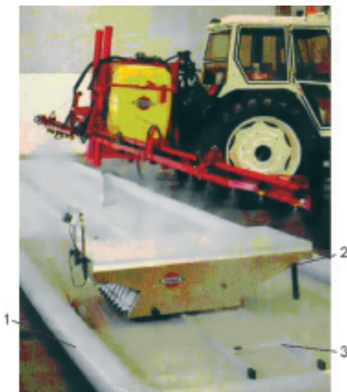
Рис. 54. Стенд для испытаний штанговых опрыскивателей: 1 - надувной бассейн; 2 – тележка-сканер; 3 – рельсы
