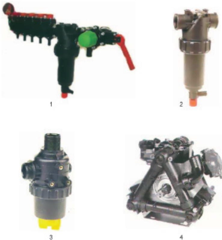
Рис. 42. Основные комплектующие для модернизации опрыскивателей: 1 – регулятор-распределитель четырех- или пятисекционный с манометром; 2 – фильтр напорный производительностью 80-280 л/мин и точностью фильтрации 173 мкм; 3 – фильтр всасывающий производительностью 60-260 л/мин и тонкостью фильтрации 365 мкм; 4 – мембранно-поршневой насос
