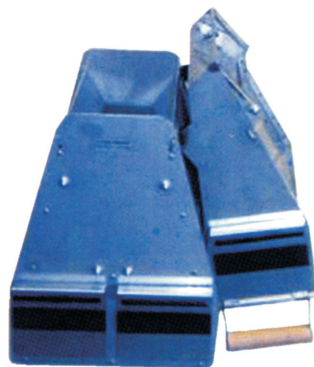
Делитель желобкового типа на 5 л. Контейнер мод. 2. Используется только с поддоном
